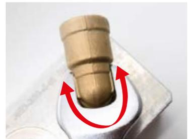
4. Fixieren Sie die gewählte Position der Verschraubung mit einer Hand und ziehen Sie die Mutter im Uhrzeigersinn nach unten an bis das empfohlene Anzugsdrehmoment erreicht ist (siehe Tabelle unten).
