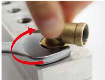
5. Die Montage der Verschraubung ist abgeschlossen.
